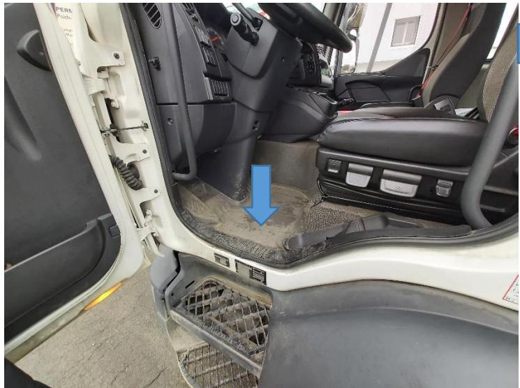
Ici ce trouve l'orifice de remplissage de l'assistance de direction, le niveau se fait cabine basculée.
