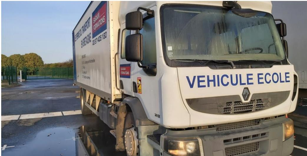
ce véhicule possède un porte-à-faux avant de 1m40 et un porte-à-faux arrière de 3m
