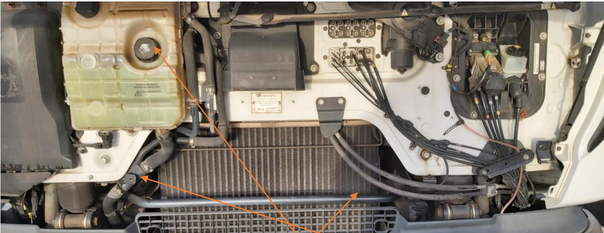
Ici ce trouve l'orifice de remplissage, du liquide de refroidissement,
