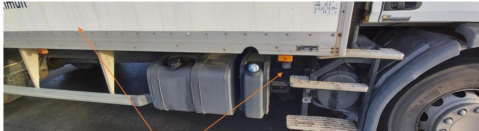
Ici ce trouve l'orifice de remplissage du liquide dépolluant.
